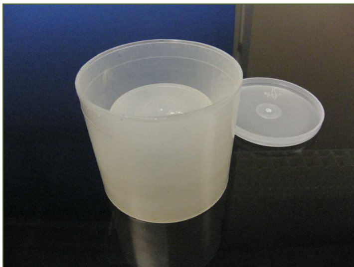
Pojemnik pomiarowy typu Marinelli (450 cm 3 ).
