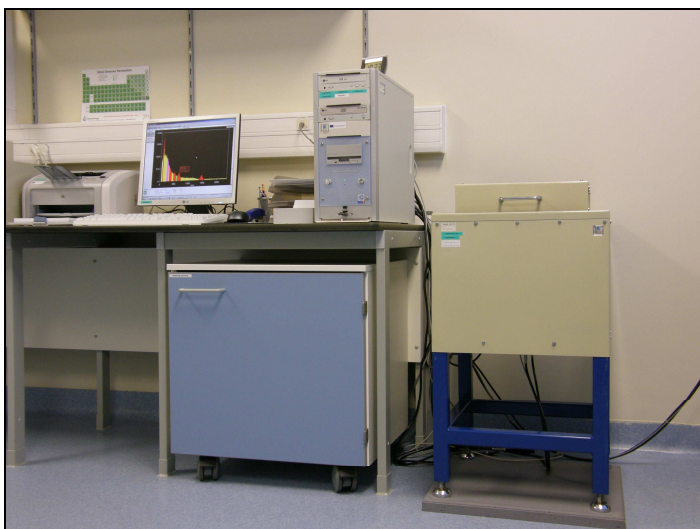
Detektor scyntylacyjny NaI(Tl) w laboratorium PIWeł-PIB.
