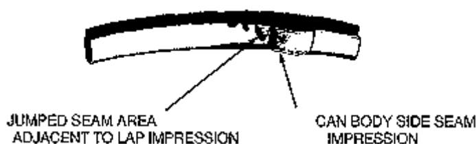
Opis zerwanego szwu Rysunek 4.1.3.j – Zerwany szew
