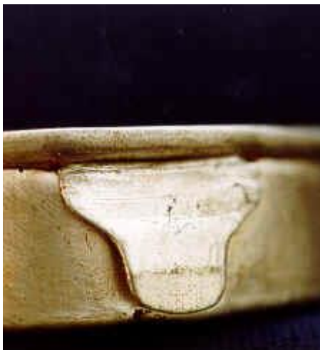
7.5.11 Wada: Zapadka z kluczykiem przymocowana szwem do wewnątrz
