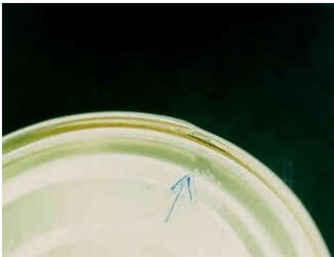
Pogłębianie się promienia ściany z zarysowaniem spowodowanym ślizganiem się narzędzia
