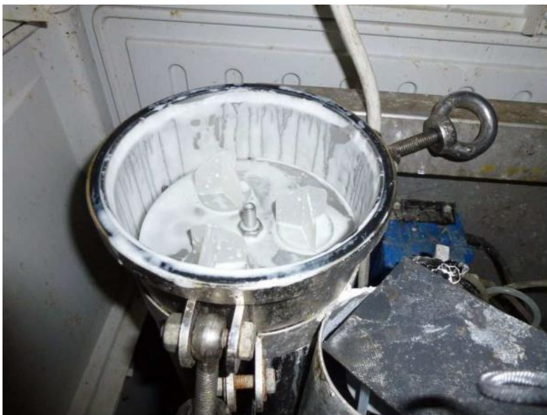
Ryc. 10 Wkłady filtracyjne o średnicy „oczek” 3\ \mu w komorze ze stali nierdzewnej.
