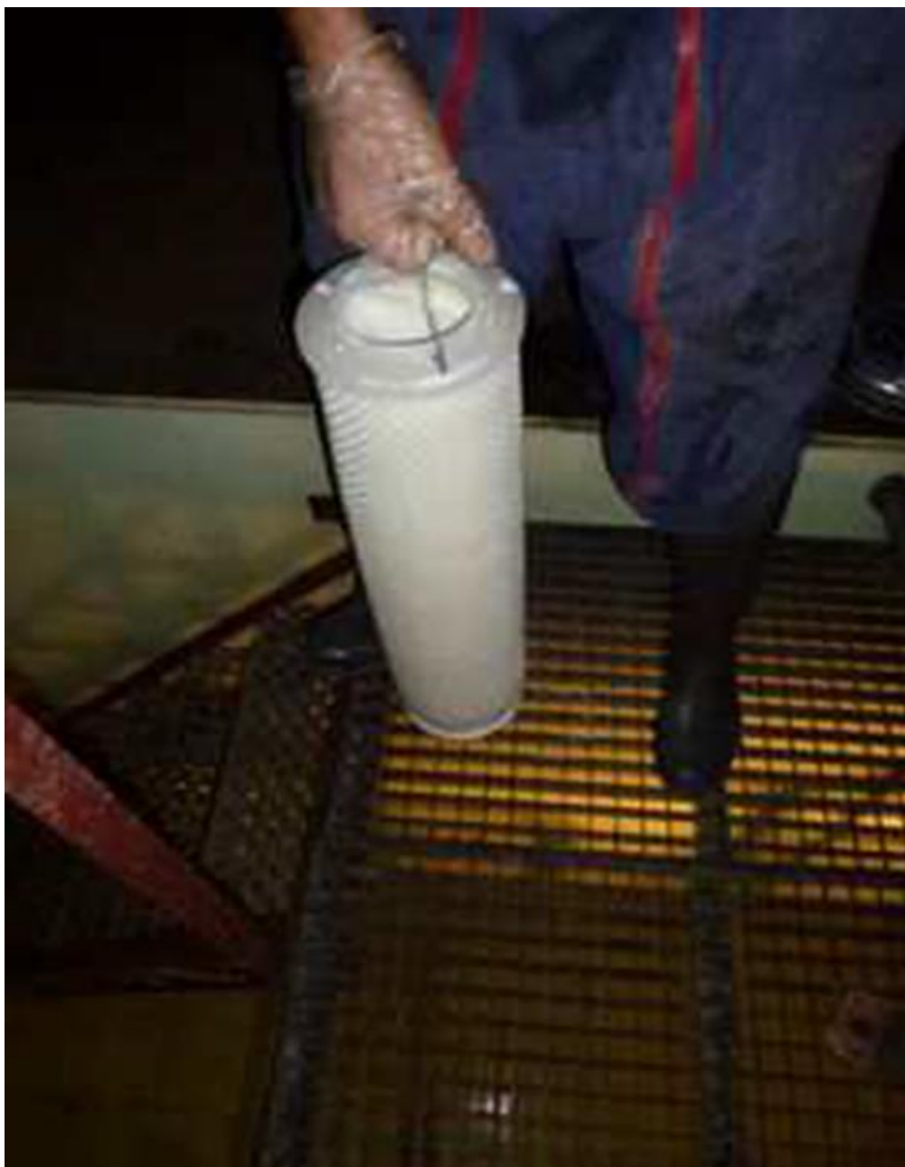
Ryc. 8 Wkład do filtra o średnicy „oczek” 10 \mu , który następnie jest umieszczany w komorze z nierdzewnej stali.
