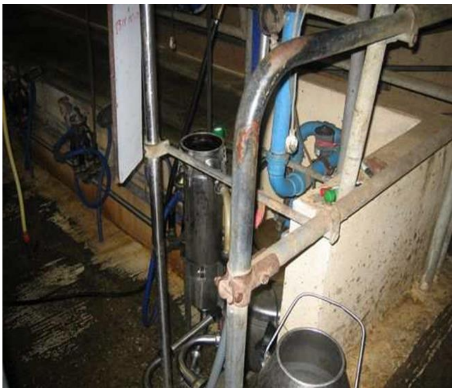
Ryc. 6 Filtr do mleka umieszczony w pomieszczeniu do prowadzenia udoju.
