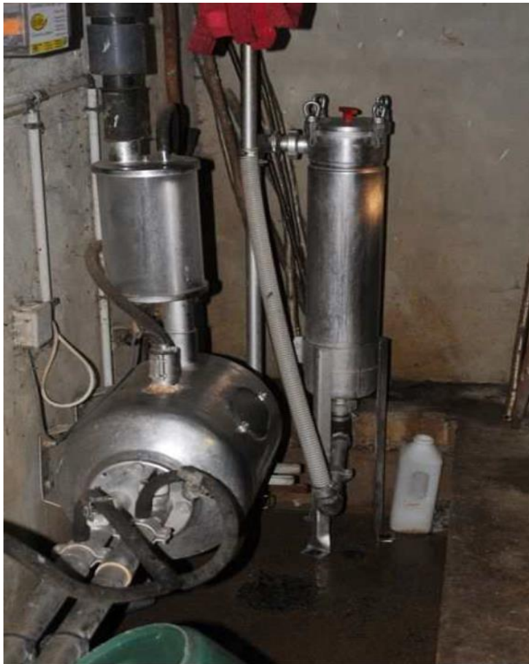
Ryc. 5 Filtr do mleka - komora ze stali nierdzewnej z wkładem wewnętrznym o średnicy „oczek” 10 \mu . Urządzenie używane w trakcie udoju i umiejscowione pomiędzy pompą a zbiornikiem do przechowywania mleka.
