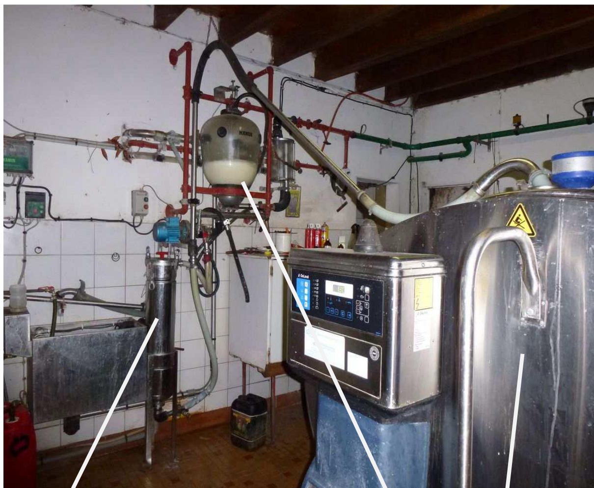
Ryc. 9 Komora ze stali nierdzewnej z wkładem wewnętrznym o średnicy „oczek” 10 \mu .
