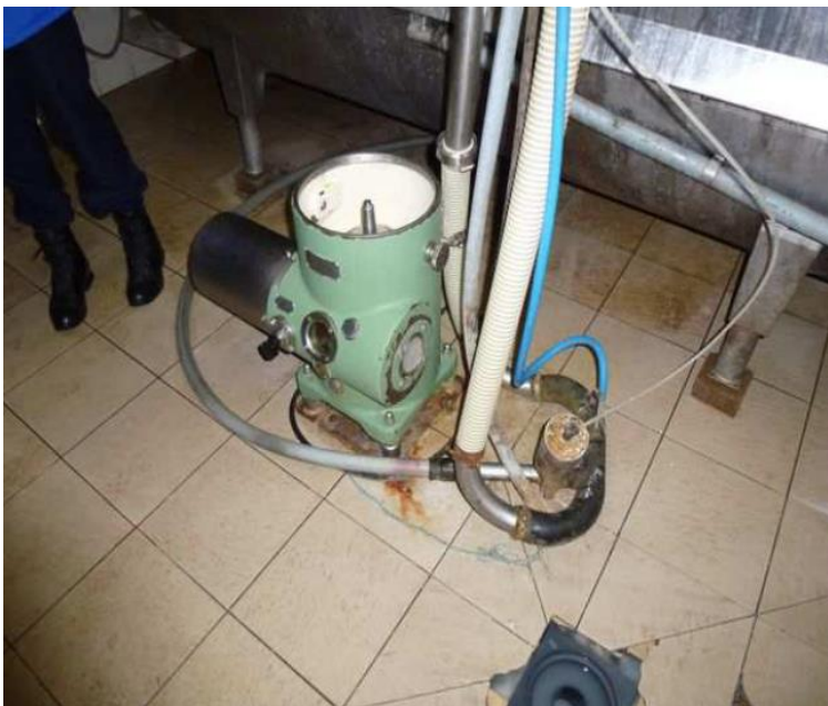
Ryc. 4 Wirówka umieszczona obok zbiornika do przechowywania mleka
