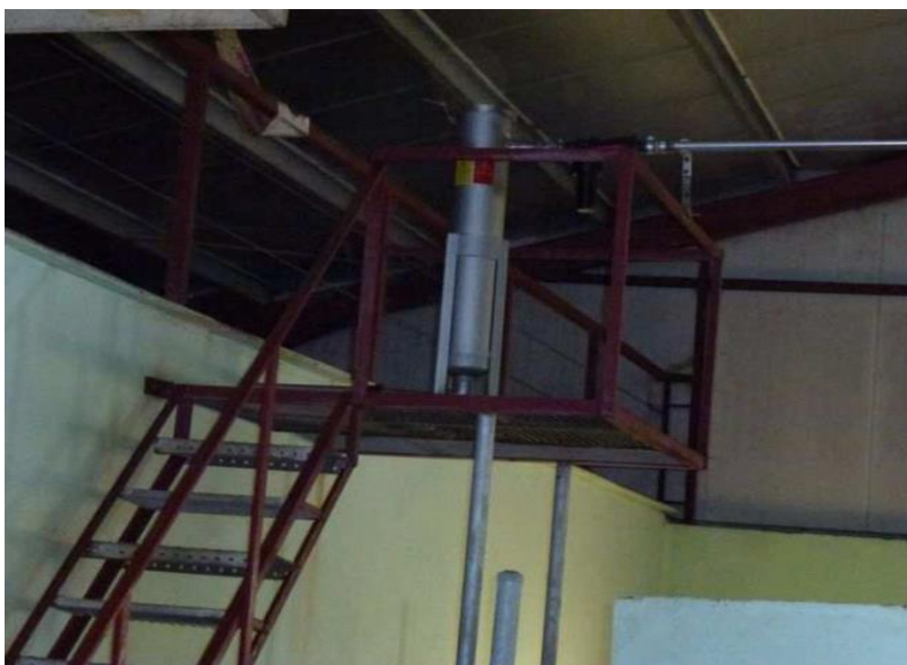
Ryc. 7 Komora ze stali nierdzewnej z wkładem wewnętrznym o średnicy „oczek” 10 \mu .
