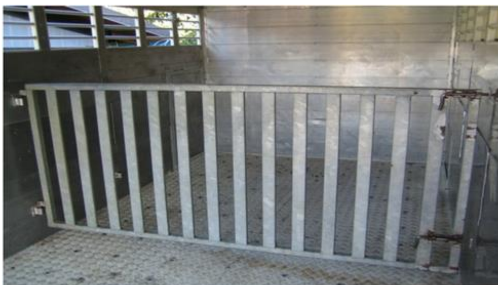
Rys. 5. Przykład niewłaściwej przegrody.
