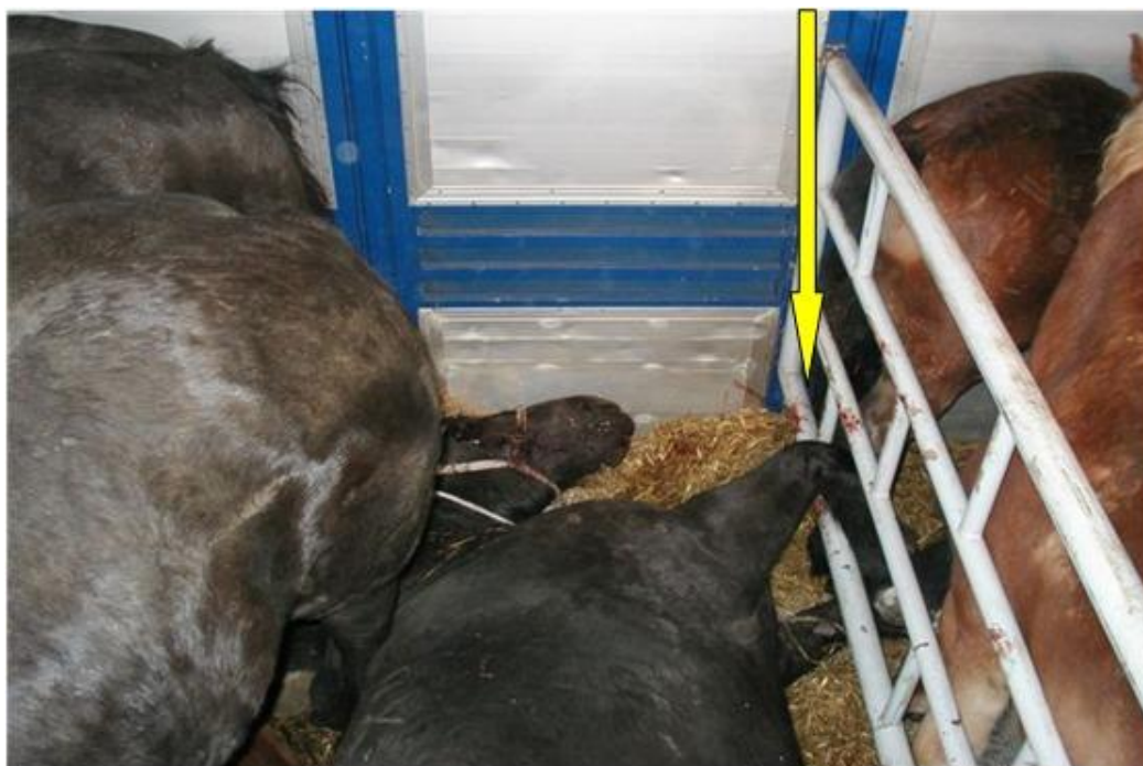
Rys. 6. Przykład niewłaściwej przegrody.
